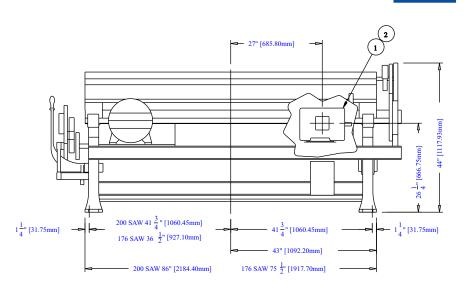
1] 176 SAW DRIVE MOTOR - 2 HP - 60 HZ / 3 HP - 50 HZ
